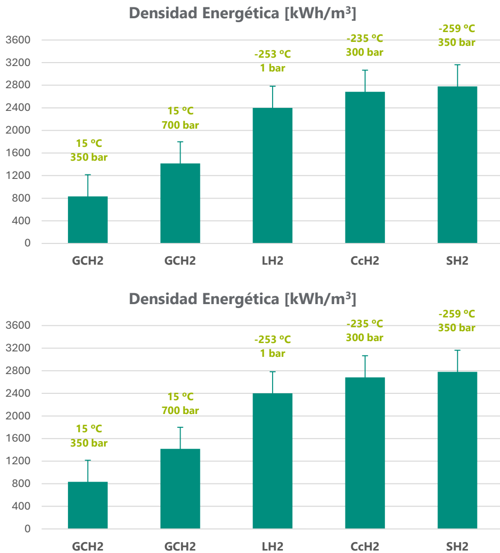
Figura 24.- Densidad energética del hidrógeno en función de la presión y/o temperatura. Fuente: Elaboración propia
