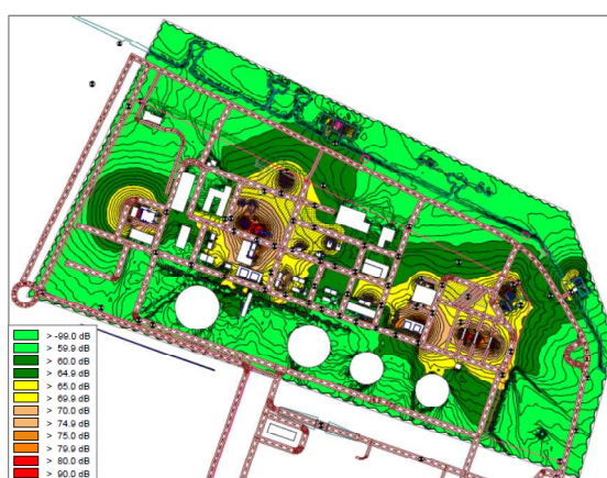
Mapa de ruido de la Planta de regasificación de Barcelona en condiciones de producción media
