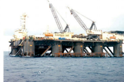
Plataforma marina Castoro Sei que se utilizó en el tendido del gasoducto submarino a Baleares
